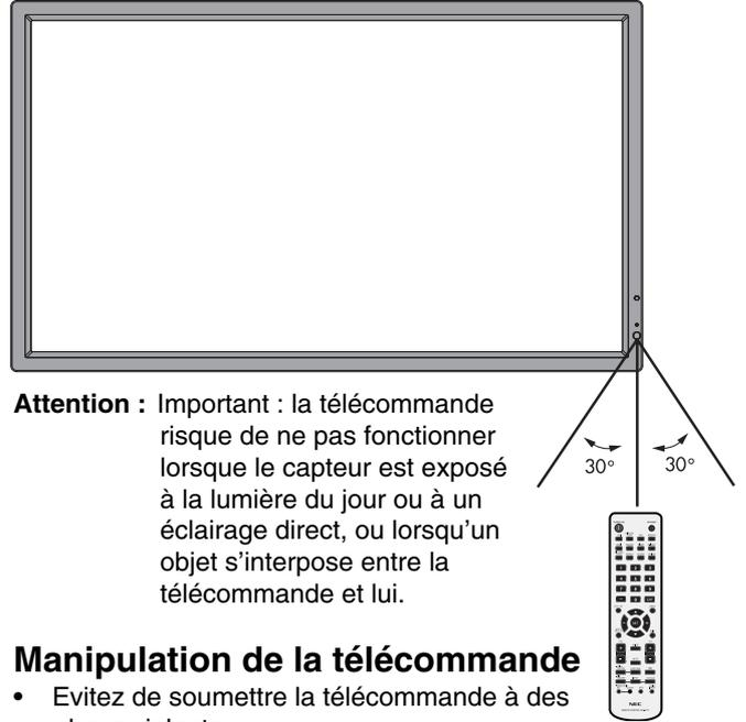
**Attention** : Important : la télécommande risque de ne pas fonctionner lorsque le capteur est exposé à la lumière du jour ou à un éclairage direct, ou lorsqu'un objet s'interpose entre la télécommande et lui.
