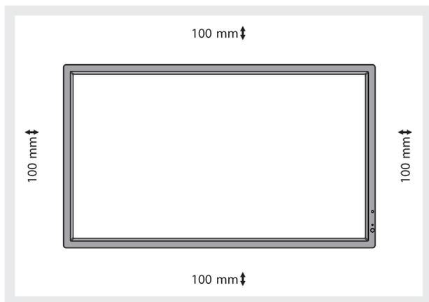
Laissez assez d'espace ou installez un système d'air conditionné autour du moniteur, de manière à ce que la chaleur soit correctement dissipée autour de l'appareil et de son support, particulièrement lorsque vous utilisez les moniteurs pour plusieurs écrans.
