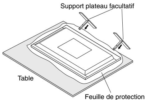
**REMARQUE :** Installez le support dans la direction indiquée par la flèche imprimée sur la surface du support. Utilisez ST-322 pour V323-2.
